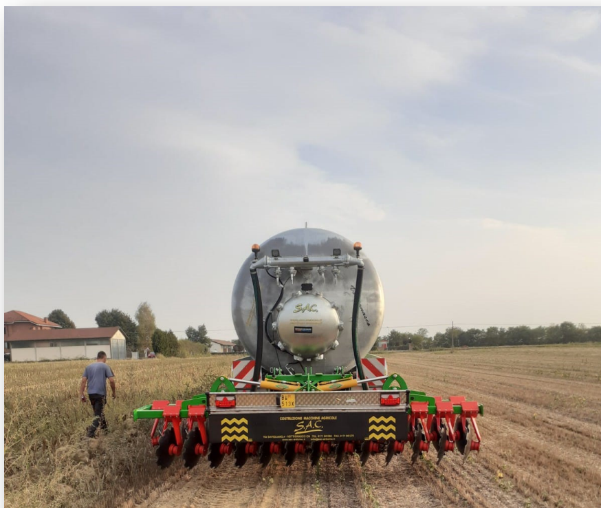
Figure 18, 19 e 20: mezzi aziendali per la distribuzione e l'interramento dei liquami
